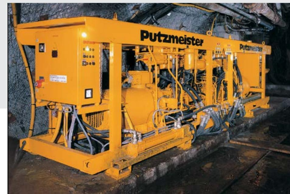
stoffpumpe so konzipiert, dass sie ohne Demontage der Förderleitung oder saugseitiger Einrichtungen schnell ausgewechselt werden können.
