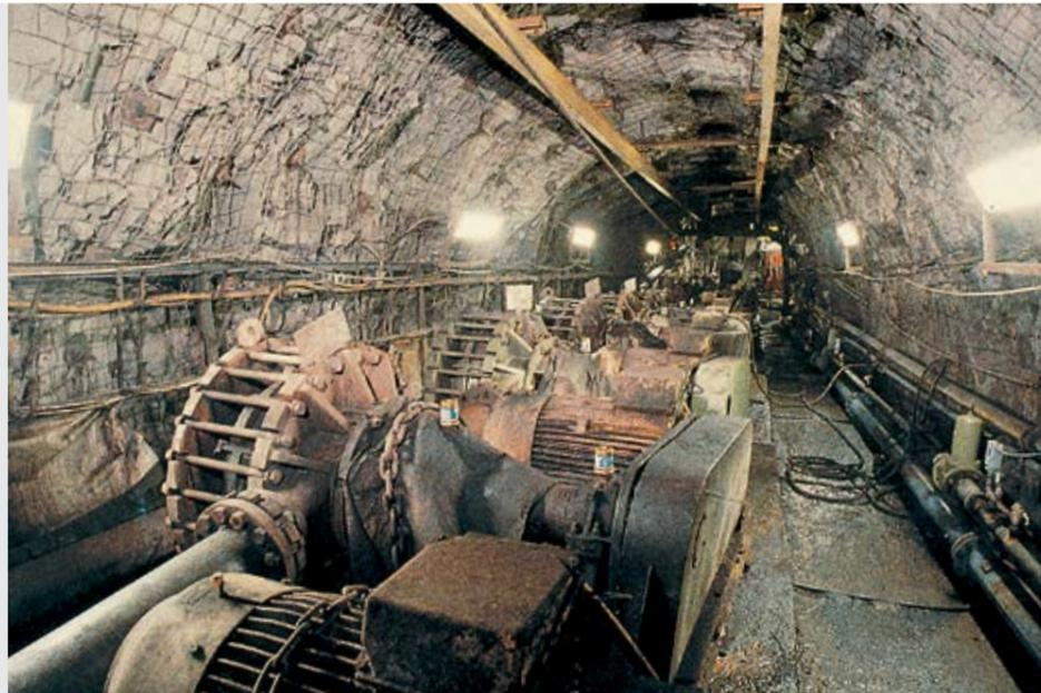
Blick in den ehemaligen Schlammumpfenraum auf der 686-Meter-Sohle. Die 12 Einkammer-Zentrifugalpumpen waren in Reihe geschaltet und förderten die sandbeladenen Wasser über 141 m zur nächsthöheren Sohle auf 545 m Höhe.
