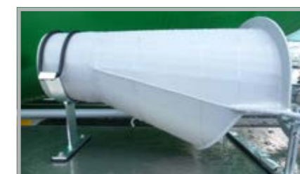
Calha de escoamento de betão
