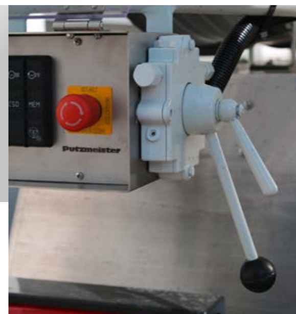
Alavanca de comando da velocidade do tambor e do sentido de rotação
