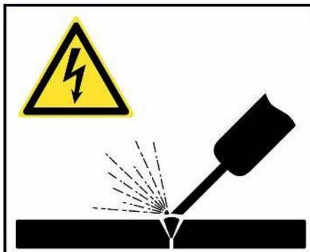
Las tensiones ajenas que pueden darse durante procesos de soldadura eléctrica pueden destruir componentes electrónicos. Por este motivo:
