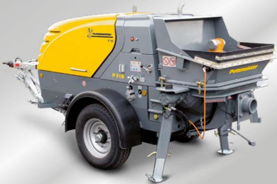
Поршневой насос Р 718 идеально подходит для нанесения торкретбетона и для подачи мелкозернистого бетона с размером фракций до 32 мм.
