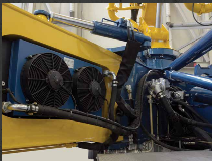
SISTEMA DE ACEITE HIDRÁULICO DE GRAN RENDIMIENTO 3
