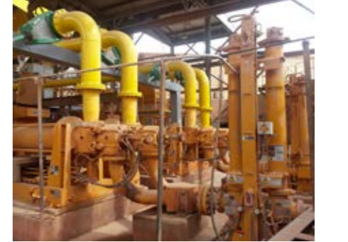
VPD Sistem, cevher atığı nakli için HSP piston pompa sistemi sonrası montaj edilmiştir.
