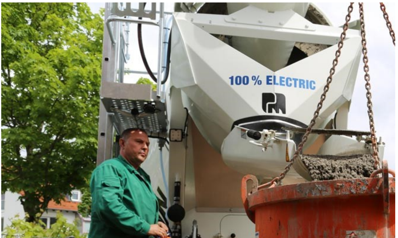
Betonpumpe oder Betonkübel – gearbeitet wird ganz normal mit dem eMischer.
