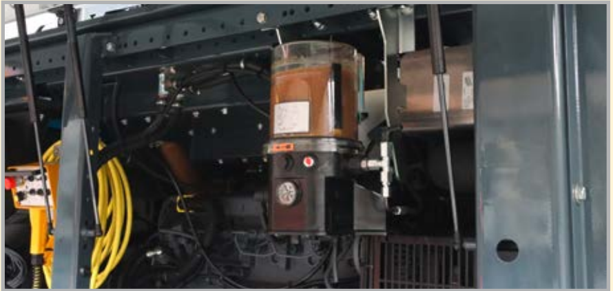
La lubricación de grasa central eléctrica ahorra tiempo de trabajo y minimiza el desgaste
