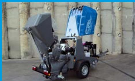
O inovador conceito de cobertura com parte traseira amovível permite uma elevada acessibilidade a todos os pontos importantes de assistência e de manutenção
