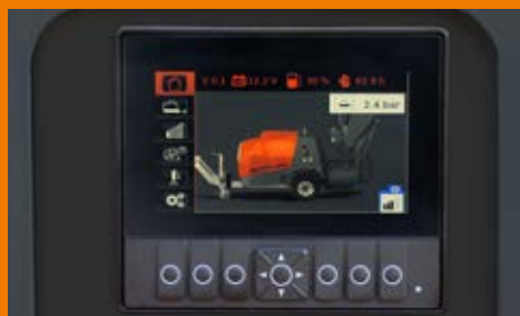
Nouveau concept de commande remanié : L'opérateur peut voir et régler toutes les informations nécessaires directement depuis le poste de commande.
