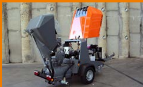
Le nouveau concept de capot et la partie arrière amovible permettent une grande accessibilité à tous les points de service et d'entretien importants.
