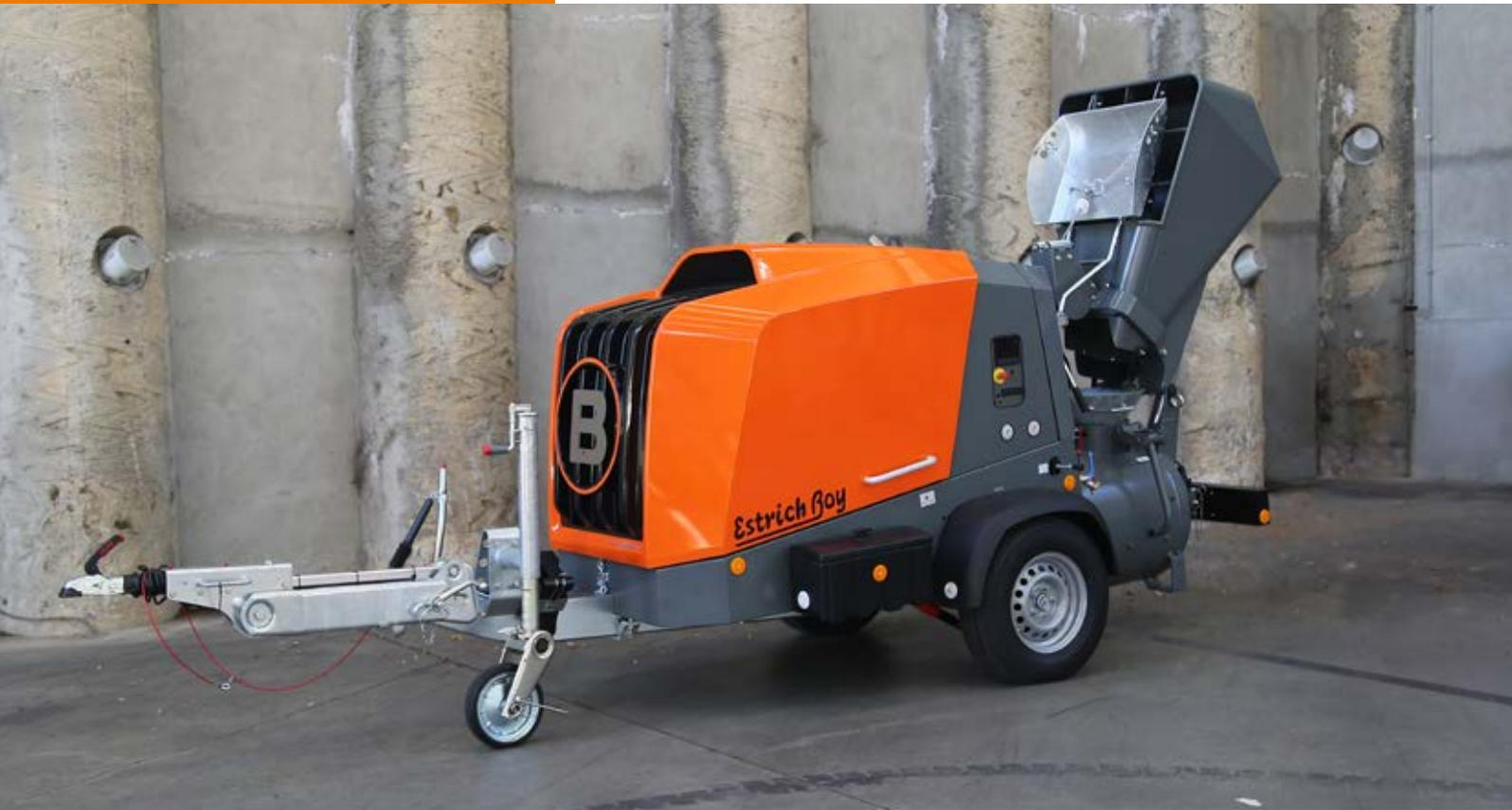
**Pour la chape traditionnelle semi-sèche avec différents additifs de liant tels que le ciment, l'anhydrite, etc.**
