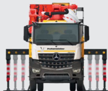
Largeur de stabilisation variable
