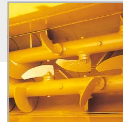
Tornillo de alimentación doble con mezclador de paletas en tolva de recepción
