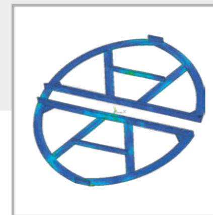
Cálculo de elementos finitos para el bastidor deslizante
