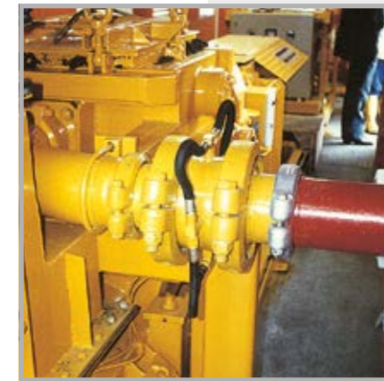
Arriba: Sistema de inyección de lubricante Abajo: Inyección de lubricante
