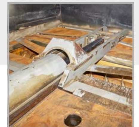
Bastidor deslizante de salida de silo rectángulo PDL
