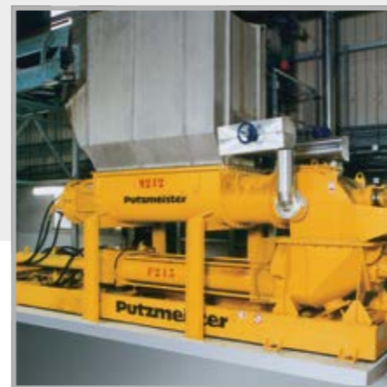
Instalación de reciclaje de basura orgánica en Varenne-Jarcy, Francia: la KOS 2180 bombea biomasa a una instalación de fermentación
