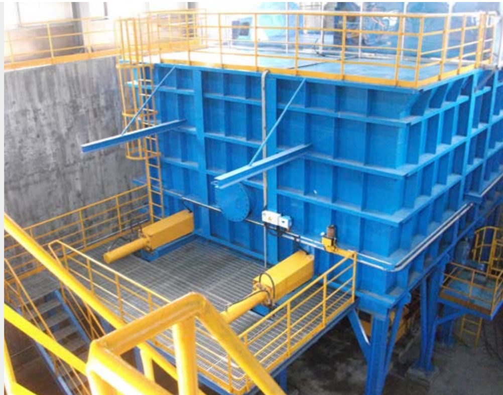
Вверху: Компактные и хорошо себя зарекомендовавшие: приводные цилиндры, расположенные на дне накопителя
