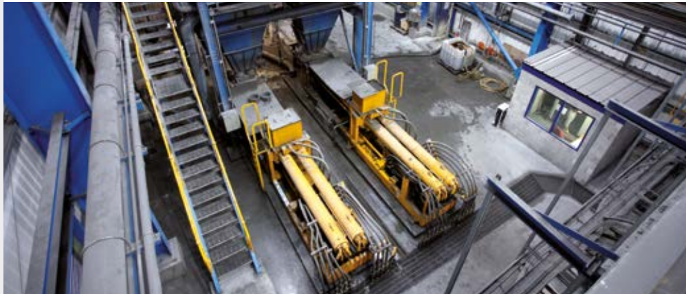
Azami basıncı düşürmek için PCF kontrol ile 2 adet HSP 25100 Pompa Sistemleri (Lisheen Kurşun/Çinko Madeni, İrlanda)
