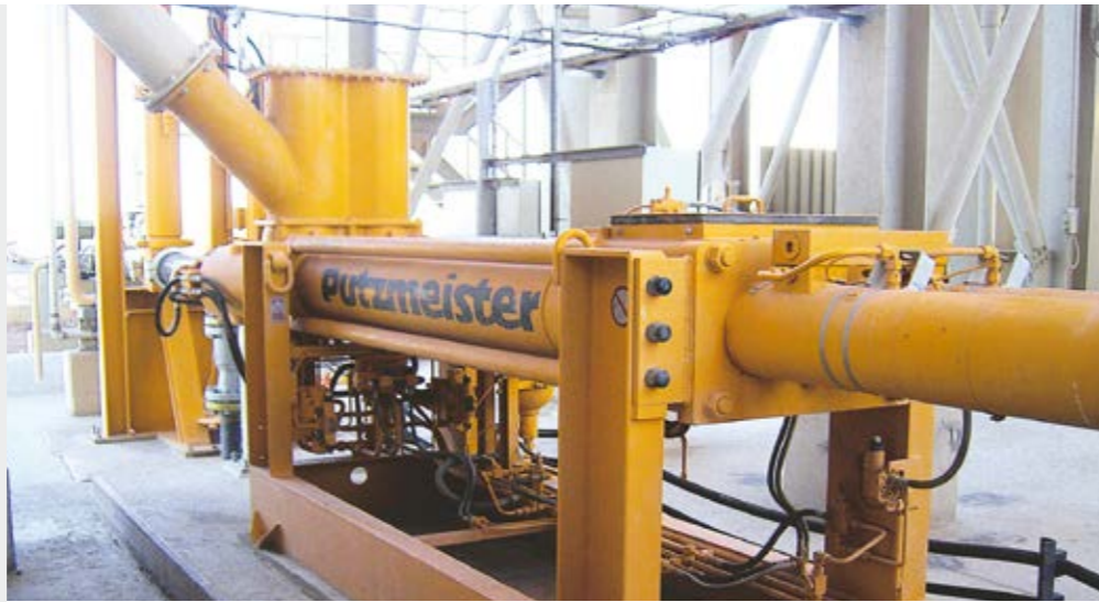
Насос с подводной трубой на шахте "Плутоник Голд Майн" ("Plutonic Gold Mine"), Западная Австралия
