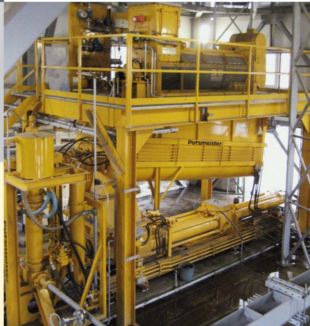
Поршневым насос типа KOS 2180 HP с мешалкой и накопителем Jumbo Trough (JT 7000)
