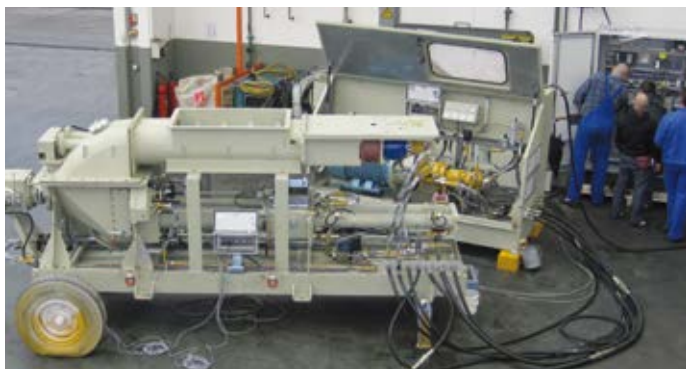
在Aichtal工厂测试间, KOS柱塞泵正在进行标准及中、高电压的测试
