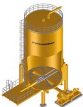
带有滑架并给泵进料的储存仓
