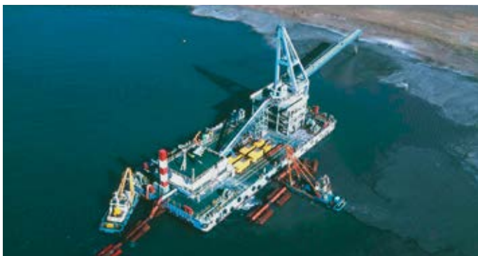
Три огромных поршневых насоса типа KOS 25100 и KOS 25200 откачивают морской ил для создания искусственного острова вдоль побережья Японии
