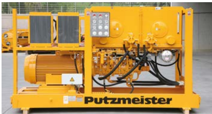
Маслостанция со встроенной гидравлической насосной секцией
