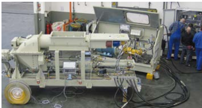
Насос типа KOS на испытательном стенде в Айхтале для стандартных и высоких напряжений
