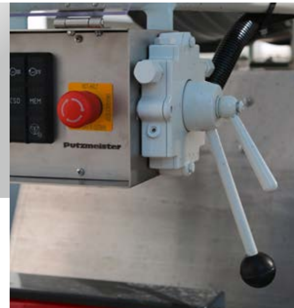
Bedienhebel für Trommelgeschwindigkeit und Drehrichtung
