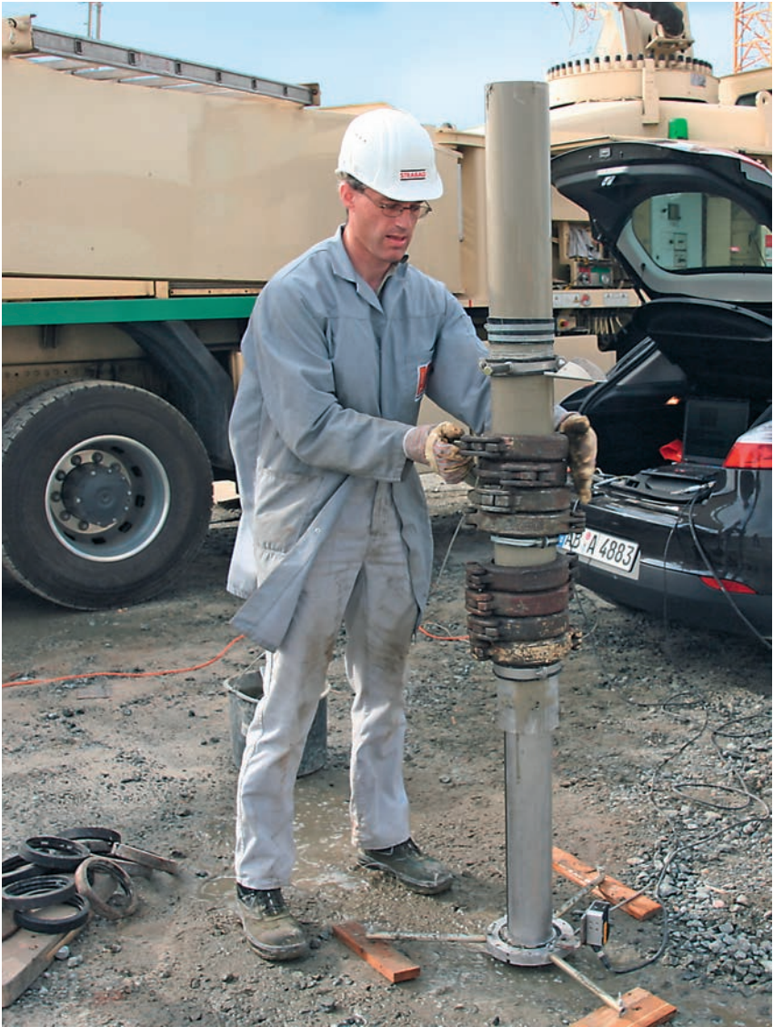
Abb. 34: Messung des Konsistenzbeiwertes von Frischbeton mit dem Sliding Pipe Rheometer
