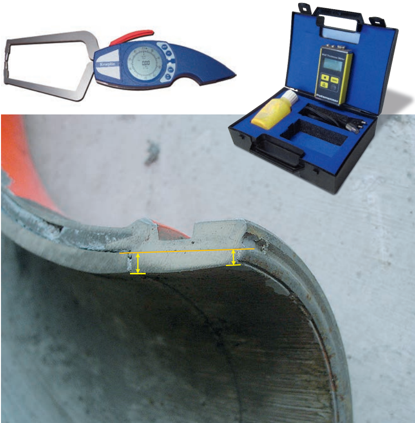
Abb. 32: Rohrverschleiß-Messung: Für Zweilagrohr eignet sich das Wandstärkenmessgerät (li.), für Einlagrohr das Ultraschall-Messgerät (re.)
