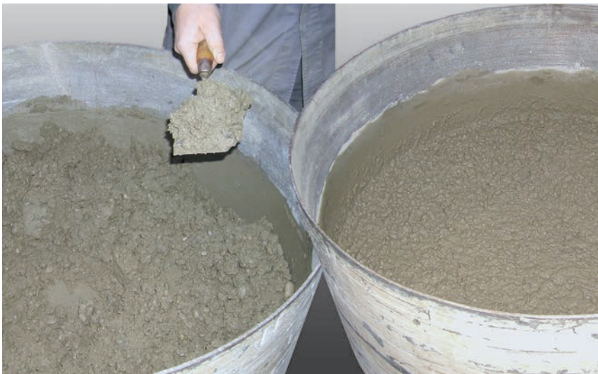
Abb. 7: Beton vor und nach der Zumischung von Fließmittel
