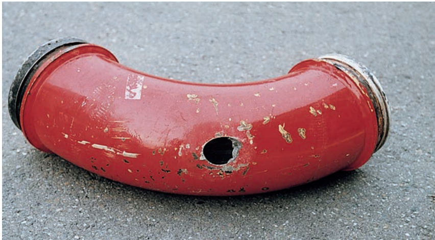
Abb. 31: Rohrverschleiß im Rohrbogen
