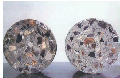
Abb. 25: Radialer Schnitt durch den Betonstrang; links Stopfer, rechts Durchfluss*
