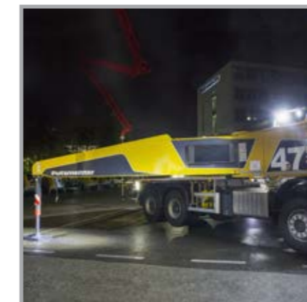
Lichtspots zum Ausleuchten der 4 Abstützpunkte machen das Aufstellen bei Dunkelheit sicherer und schneller
