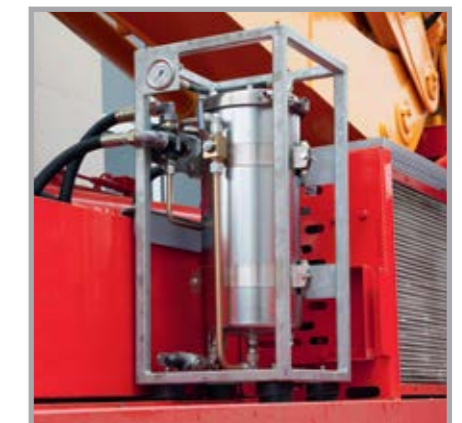
Der mobile Nebenstromfilter verlängert Standzeiten und spart Ölwechsel
