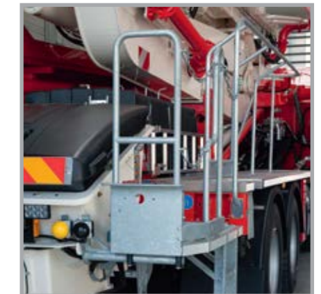
Die ergonomische Arbeitsplattform (optional) mit rutschhemmender Oberfläche bietet viel Platz für den Maschinisten
