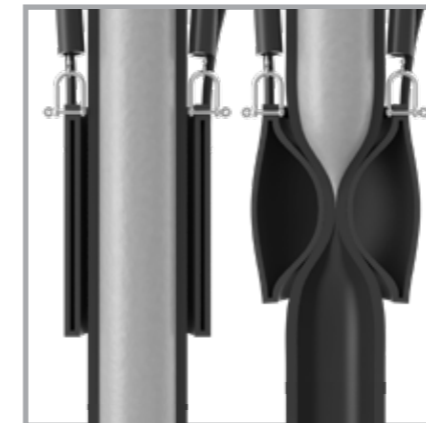
Das pneumatisch betätigte Endschlauch-Verschlussventil (EQV) unterbricht den Betonfluss und verhindert ein Nachtropfen
