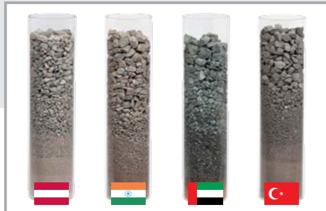
Beispiele für Betonmischungen aus 4 Ländern (von links nach rechts): gerundete Kiesel aus Österreich, gebrochene Steine aus Indien und Dubai, besonders scharfkantig und hart sind die Zuschlagstoffe der Probe aus der Türkei ganz rechts. Zu sehen sind die Sieblinien der Zuschlagstoffe von fein (unten) nach grob (oben).
