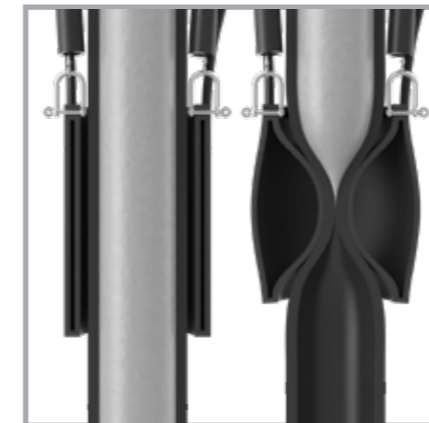
Das pneumatisch betätigte Endschlauch-Verschließventil (EQV) unterbricht den Betonfluss und verhindert ein Nachtropfen
