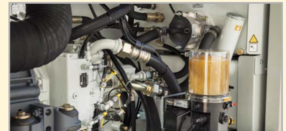
La centrale de graissage électronique fait économiser du temps de travail et diminue l'usure
