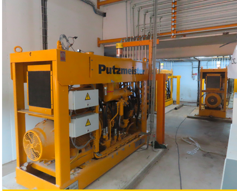
Üçüncü hattın HA 55 E hidrolik güç ünitesi, diğer ikisi arka planda görülüyor
